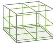
Der PLANO 4D GREEN ist ein selbstnivellierender Linienlaser mit vier REAL GREEN 360° Laserlinien für horizontales und vertikales Nivellieren. Die bodennahe, horizontale Laserlinie erweitert die vielfältigen Anwendungsmöglichkeiten eines Multi-Linienlasers im Innenausbau. Insbesondere Bodenarbeiten können mit Hilfe der bodennahen Laserlinie präzise ausgeführt werden.
